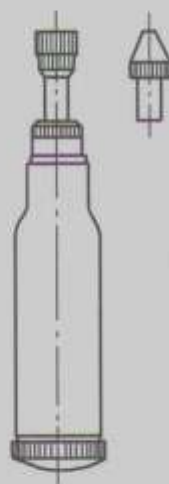
Obr. 3.6. Ruční mazací lis
